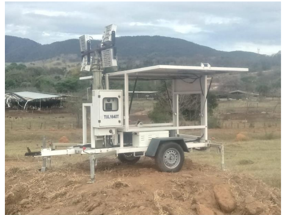
Foto 44 – Torre de iluminação com placa de energia solar vistoriado. (Data: 22/09/20)
